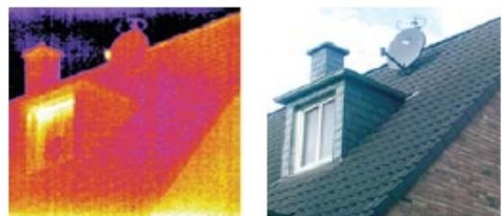
Detektion von Wärmebrücken an Gebäuden
